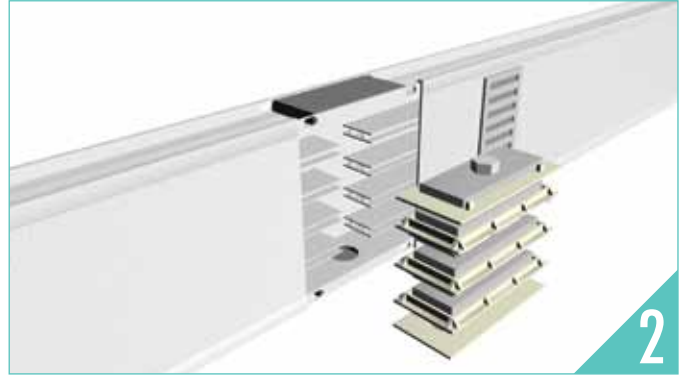
2) Monoblok ek elemanını işlem için hazırlayınız. 2) Prepare the monoblock joint element to install. تحضير وصلة القطعة الواحدة للتركيب
